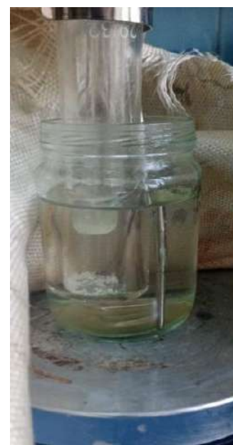
Рисунок 5.23 – (а) Результат рентгенофазового анализа продуктов ресублимации сокристалла [CBZ+4-ОН-BZA] (1:1) и (б) фотография охлаждающего пальца трубки Шленка после эксперимента при температуре 150°C (время выдержки 24 часа).
