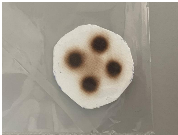
Рисунок 5 – Мембраны с пятнами частиц черного углерода с четко выраженными границами
