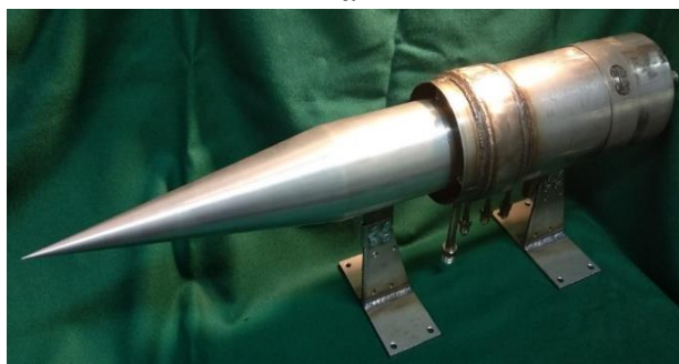
Рисунок 12. Образец прямоточного НДД: а – трехмерная модель в разрезе; б – фотография экспериментального образца НДД
