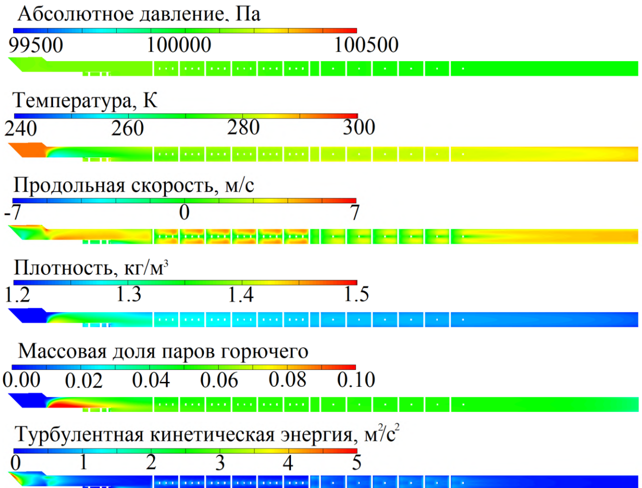
Рисунок 16. Расчетные поля параметров течения в тракте ИДД с форкамерой снизу при холодной продувке горючей смесью без препятствий–турбулизаторов в воздухозаборнике [146]
