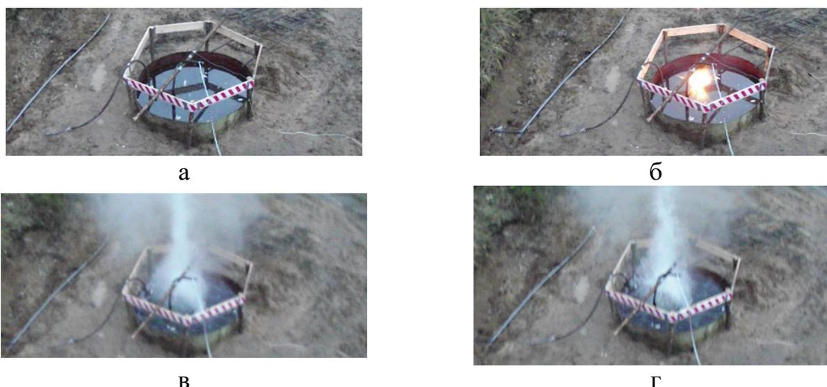
Рисунок 17. Последовательные кадры взрыва аммонита на глубине 0.5 м: а – 0 мс; б – 8 мс; в – 12 мс; г – 15 мс
