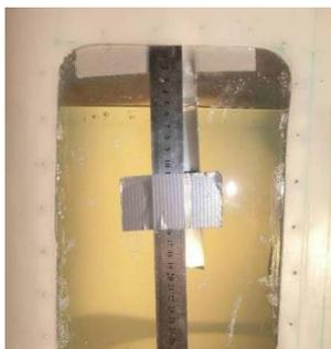
Рисунок 40. Устройство для определения уровня воды и объемного содержания пузырьков в колонне
