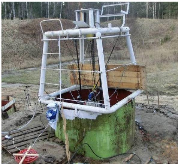
Рисунок 26. Основная емкость после проведения серии экспериментов выдвинулась из грунта на 0.7 м
