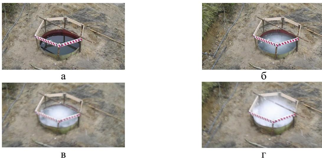
Рисунок 16. Последовательные кадры взрыва аммонита на глубине 1 м: а – 0 мс; б – 8 мс; в – 12 мс; г – 15 мс
