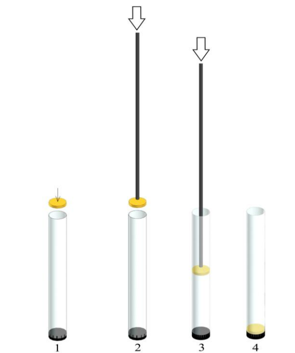
Рисунок 5.8 – Порядок установки первого слоя композитного стержня
