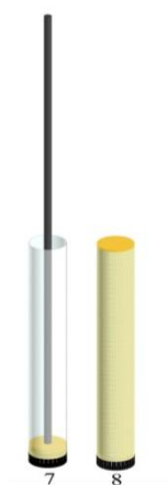
Рисунок 5.10 – Установка третьего слоя (7) и схематическое изображения скомпонованного образца (8).
