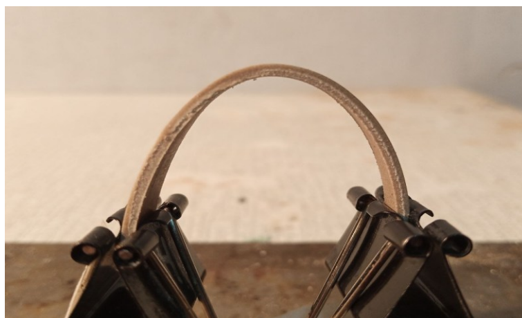
Рисунок 64 – Гибкость образцов ПФА/СЭВА (80/20) масс. % при комнатной температуре
