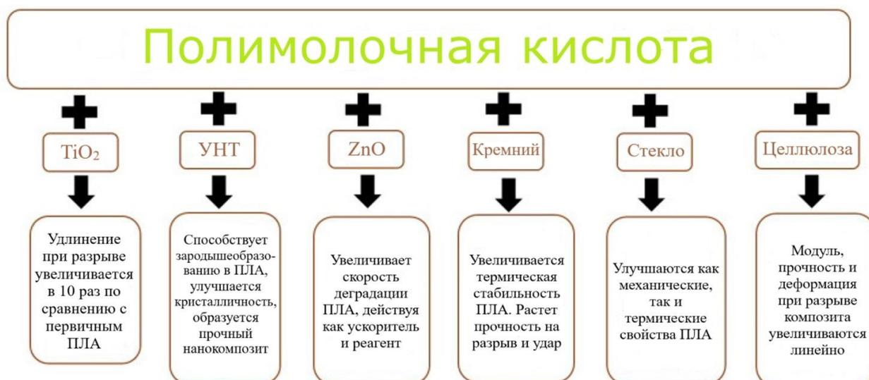
**Рис. 1.8.** Влияние некоторых типичных нанонаполнителей на свойства ПЛА.
