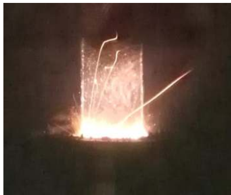
Абляционное облако над поверхностью мишени
