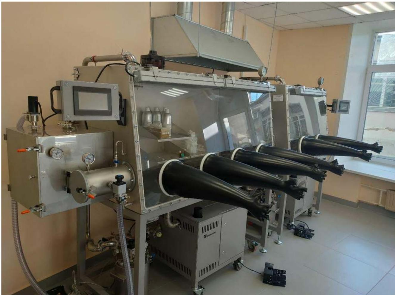
Перчаточные боксы Vilitek VBOX PRO - современный эффективный вариант оборудования для проведения работ, требующих высокую и ультравысокую очистку рабочей зоны от кислорода, влаги и микроорганизмов
