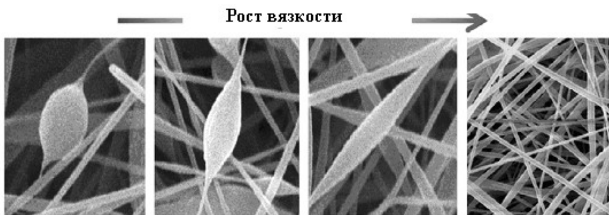
Рисунок 50 - Влияние возрастания вязкости (концентрации) полимерного раствора на форму каплеподобных утолщений ультратонких волокон полиакрилонитрила, полученных методом ЭФ. [415]
